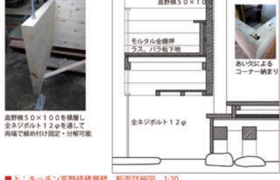
■ 上：キッチン高野積積層壁 断面詳細図 1:20
