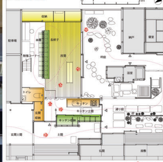
● 高野積積層壁 ● 吉野杉小幅板材 ● 吉野積貫壁 ● 既存建物 ● 写真アングル ..... 坪庭や通り土間から滑らかに連続する回遊動線
